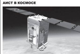
«Аист-2Д» – малый космический аппарат прошел испытания. Он снабжен ультралегкими каркасами солнечных батарей. Сами батареи изготовлены из углеродистого волокна и весят всего 500 г/м2. Аист-2Д уже успел отстыть 14 миллионов км поверхности Земли. Конструкция не имеет аналогов и запатентована только в России. Кроме того при производстве аппарата были использованы панели терморегуляции, на которые можно устанавливать различные приборы.
