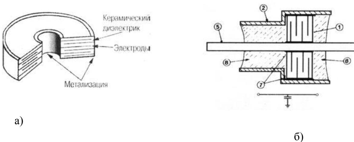
Рисунок 5.16 – Дискоидальный конденсатор (а) и его применение в конструкции проходного конденсатора (б).
