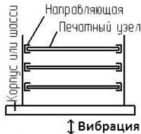
Рис. 8.2 – Эскиз конструкции блока
