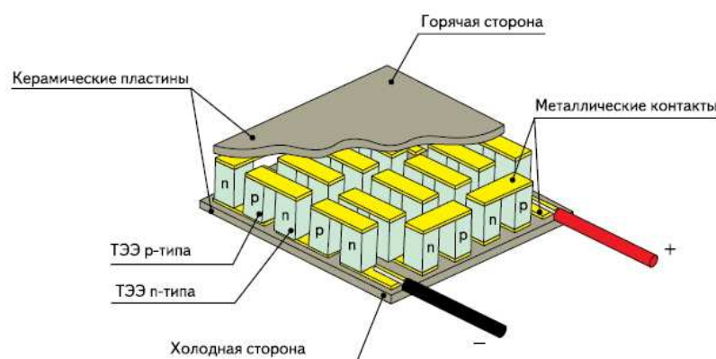
Рис. 1 – Структура термоэлектрического модуля
