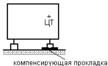
Рисунок 8.20 – Выравнивание блока с помощью прокладки
