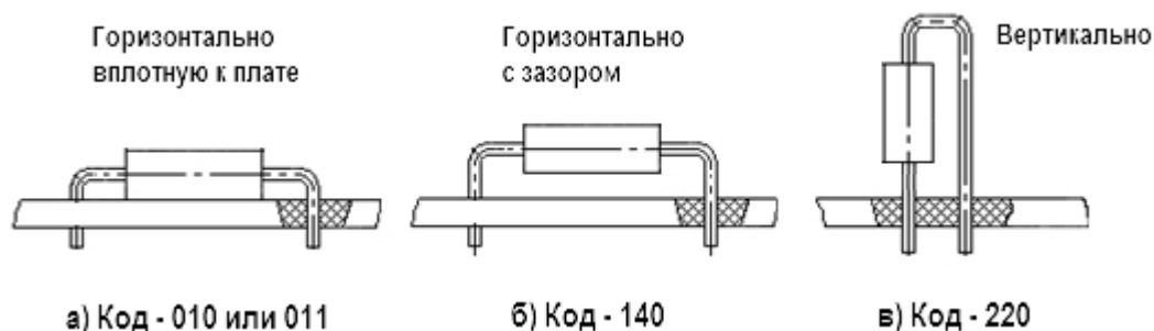
Рис. 3.3. Примеры установки КМО из стандарта [3]
