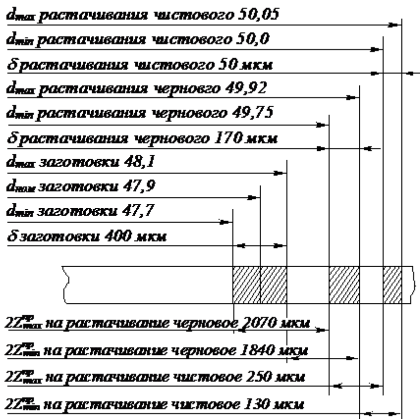
Рисунок 5.2 -Схема расположения припусков и допусков на обработку отверстия \varnothing 50^{+0,05} корпуса
