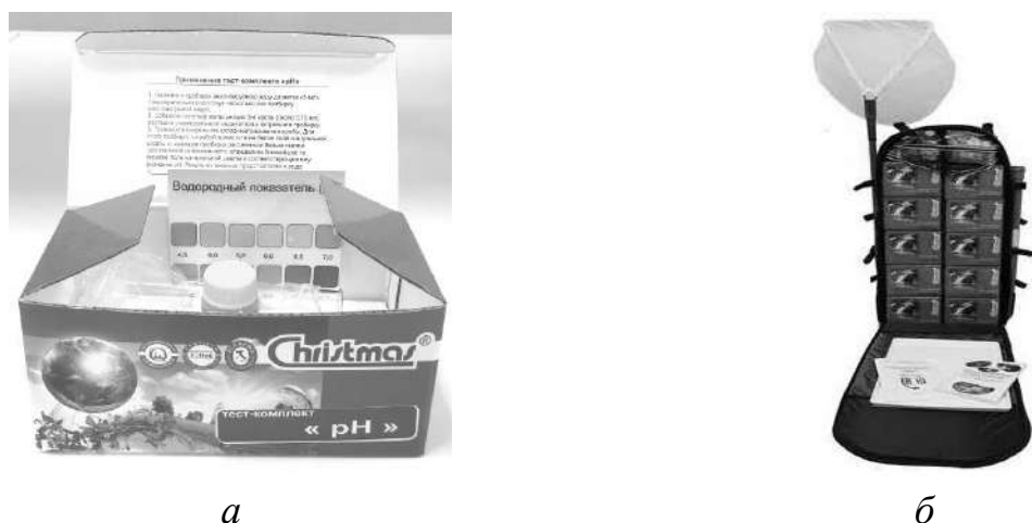
Рис. 2. Оборудование для полевых работ: а – тест-комплект; б – ранцевая лаборатория «НКВ-Р/м»
