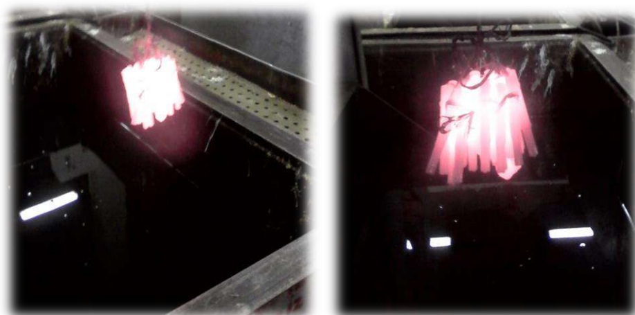
Рис. 1. Технологический процесс закалки заготовок: а) нагрев в высокотемпературной соляно-бариевой ванне; б) охлаждение в соляно-бариевой ванне на воздухе
