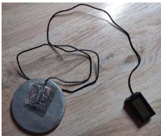
Рис. 1. Алюминиевый цилиндр с приклеенным ЧЭ покупного термометра
