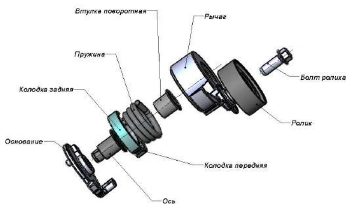
Рис.2. Конструкция натяжителя в разнесенном виде
