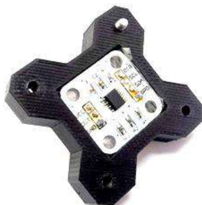
Рис.4. Крепежное приспособление с модулем энкодера
