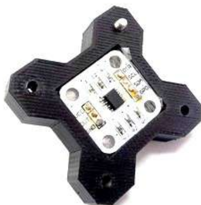
Рис.4. Крепежное приспособление с модулем энкодера
