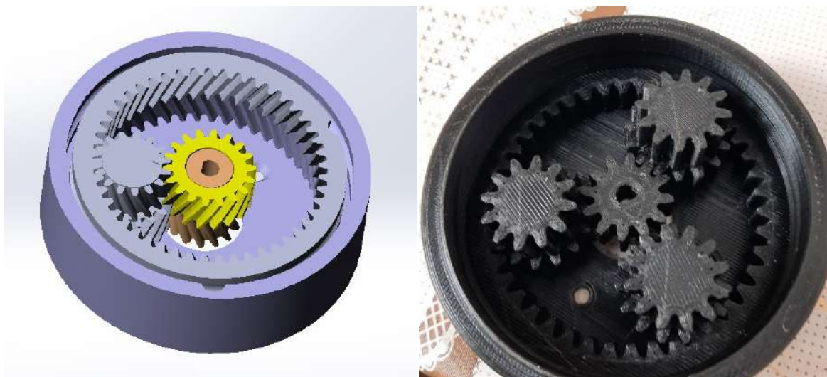
Рис. 1. 3D-модель и напечатанный вариант планетарного редуктора
