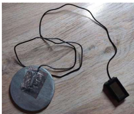
Рис. 1. Алюминиевый цилиндр с приклеенным ЧЭ покупного термометра
