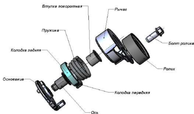
Рис.2. Конструкция натяжителя в разнесенном виде
