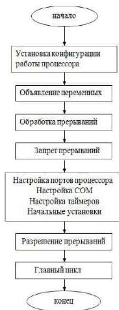
Рис. 2. Общий алгоритм работы микроконтроллера
