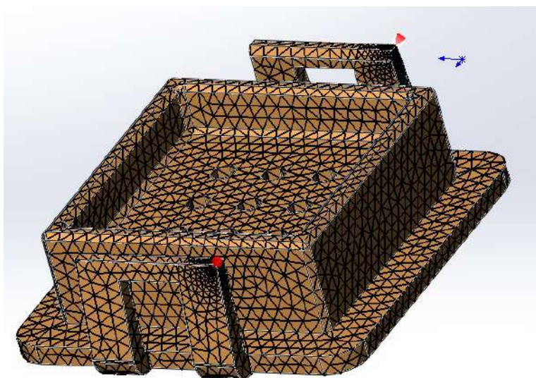
Рис. 4. Сетка КЭ для исследования
