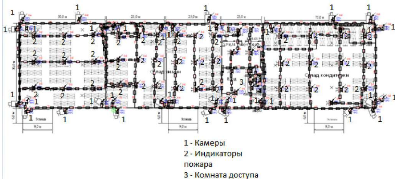
Рис. 2. Физическая схема сети
