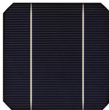
Рис. 2. Монокристаллический солнечный элемент
