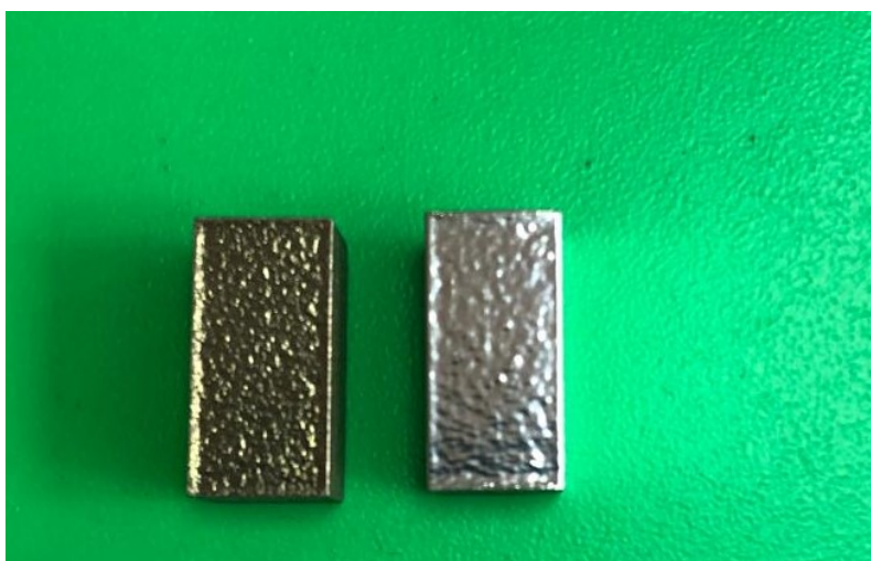
Рис. 11. Образец до СЭП (выращенный методом СЛС)
